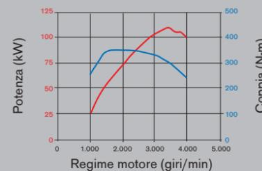
Il motore ZD30 da 3.0 litri sviluppa 150 CV e 350 Nm per le versioni 3.5t e 4.5t di MTT.
