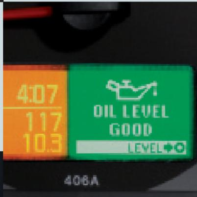
Il computer di bordo offre utili informazioni sul livello dell'olio, il consumo, la disponibilità residua di carburante, il chilometraggio, la velocità media, il filtro dell'olio, pneumatici, gli interventi di manutenzione, l'ora in formato digitale, il contagiri e il cambio marcia per una gestione ottimale della trasmissione.
