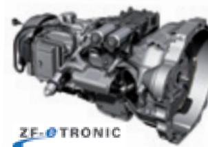
Per Cabstar è disponibile, a richiesta su alcune versioni, il cambio robotizzato a 6 rapporti ZF e-Tronic che dispone di un sistema di trasmissione intelligente, capace di adattarsi ad ogni situazione: seleziona e cambia le marce in base alle necessità riducendo l'usura del mezzo e ottimizzandone le prestazioni. È possibile comunque tornare alla modalità manuale con una leggera pressione sui comandi.
