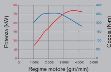
Il motore YD25 da 2.5 litri sviluppa 110 CV e 250 Nm per le versioni 2.8t, 3.2t e 3.5t di MTT.
