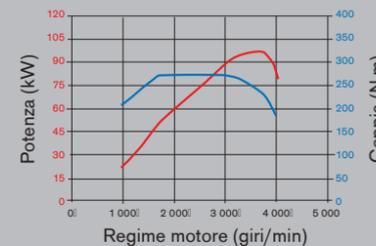
Il motore YD25 da 2.5 litri sviluppa 130 CV e 270 Nm per le versioni 3.5t e 4.5t di MTT.
